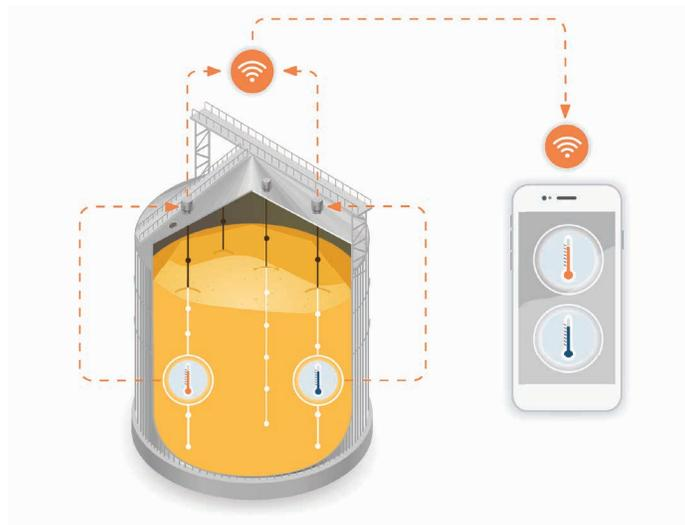
Además, existen sistemas más sofisticados que permiten monitorear la temperatura remotamente con un programa que realiza la lectura de los cables para descargarla en una base de datos.
